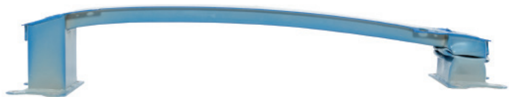
► Daño de la traviesa delantera
