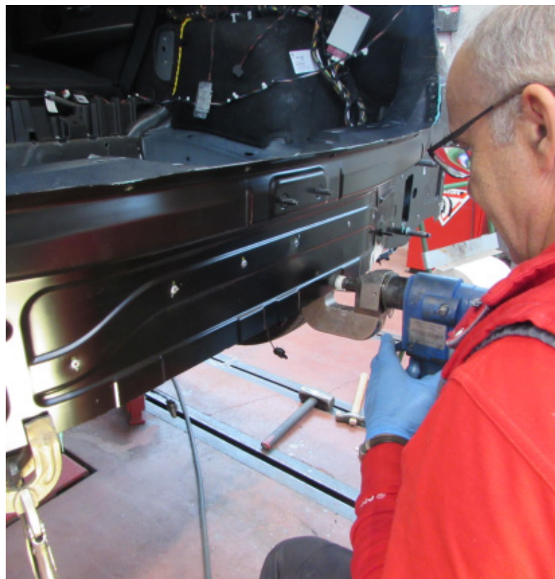
Reparación del faldón
