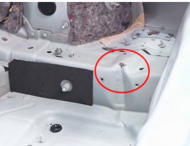
Reparación del piso maletero
