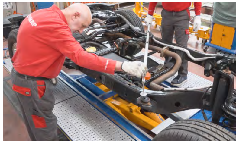
Comprobación de diagonales
