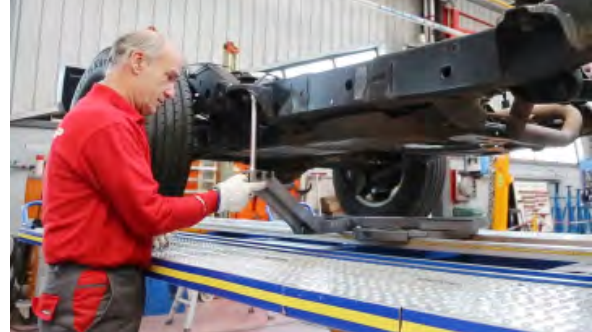
Verificación con medidor electrónico
