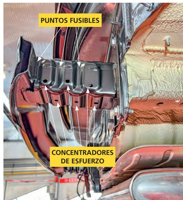
Elementos de un absorbedor de travesía trasera
