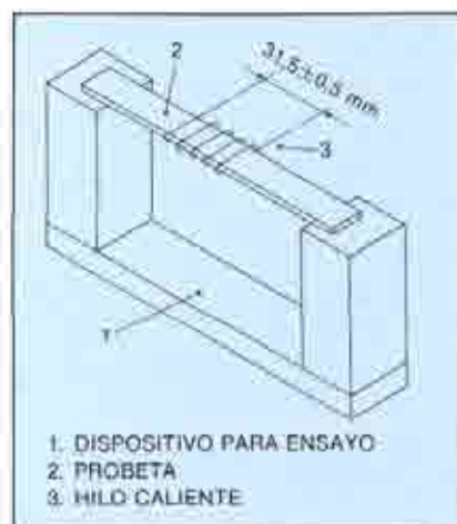
FIGURA 9. Dispositivo para el ensayo de ignición por hilo caliente (HWI), de acuerdo con UL 746A.
