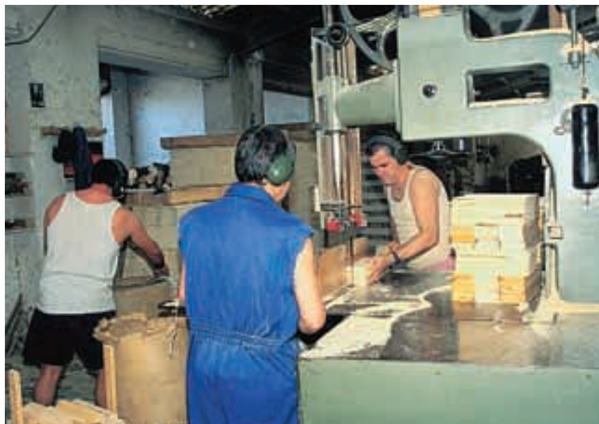
Sierra de cinta para el corte de madera. El nivel de ruido supera normalmente los 90 dB(A).
