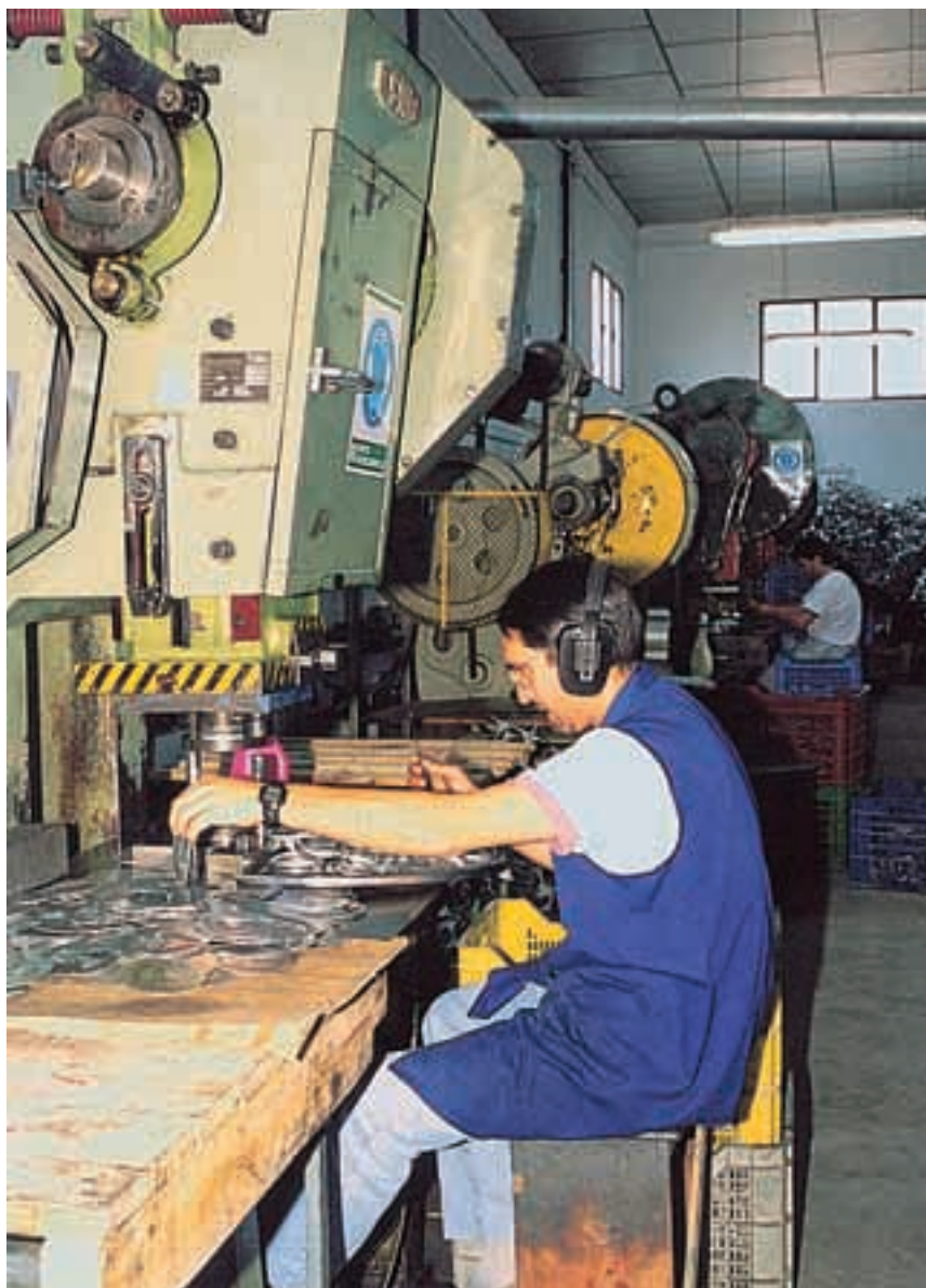
Las prensas para el troquelado y embutido de metales generan niveles de ruido muy elevados. Ante la imposibilidad de evitar la generación de ruido y de distanciar al trabajador de la máquina es necesaria la utilización de protectores auditivos.
