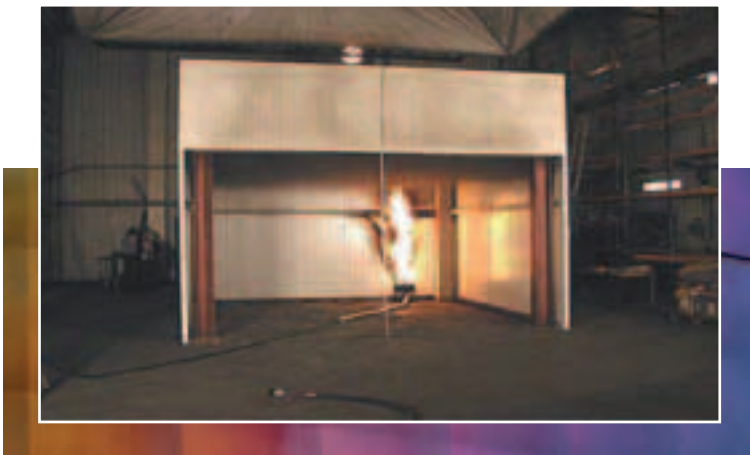
Foto 12. Sistema de ensayo ISO/FDIS 13784- 2. Ensayo en estado inicial, el sistema presenta un sistema de puerta adintelada en el extremo opuesto al quemador. Fuente: SP –Swedish National Testing & Research Institute.
