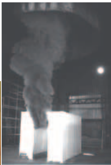
Foto 10. Ensayo Room/Corner Test (ISO 9705) en su modificación free-standing. Fuente: SP-Swedish National Testing & Research Institute.
