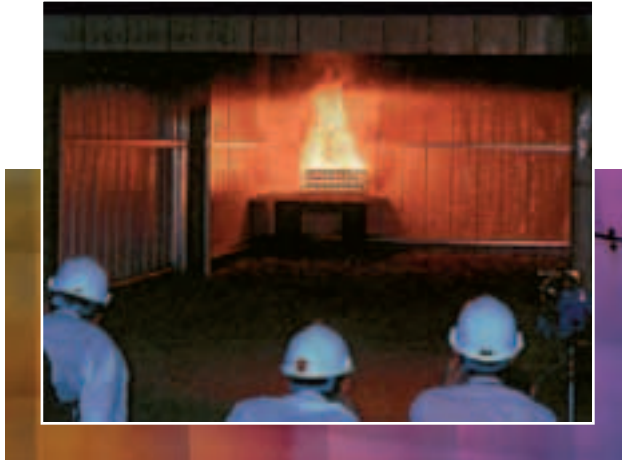
Foto 13. Interior con ensayo LPS 1181 en marcha. Fuente EPIC.
