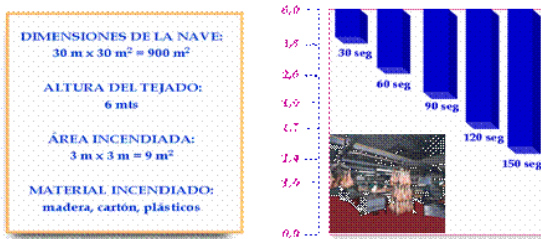
Figura 6. Progresión temporal lámina de humo desde el techo en un incendio tipo
