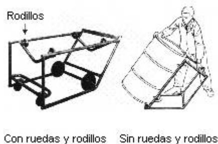
Fig. 3: Estructuras de cuna metálicas
