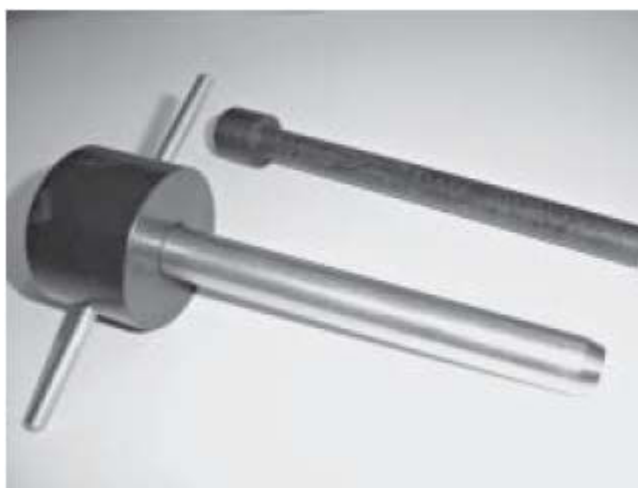
Figura 4 Equipo para toma de muestras en todo el espesor del material. Asbestos core sampling
