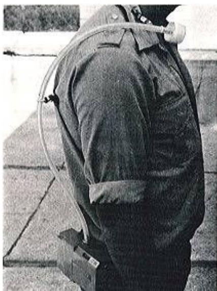
**Fig. 5: Toma de muestra con casette**
