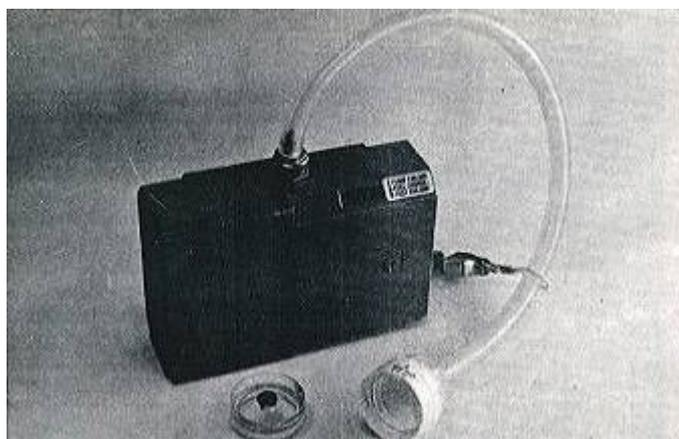
**Fig. 4: Equipo de muestreo con cassette abierto**
