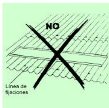
**Fig. 7: Pasarela instalada incorrectamente**
