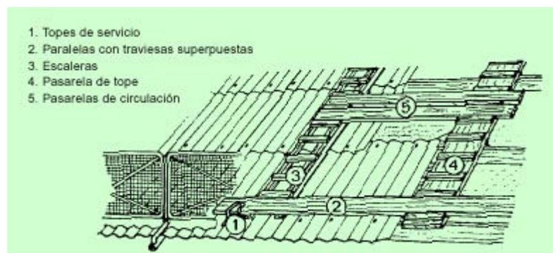
**Fig. 16: Instalación de superficies de circulación mediante pasarelas de madera**
