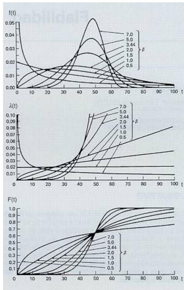
**Fig. 1: Variación de la densidad de probabilidad  $f(t)$ , tasa de fallos  $\lambda(t)$  y la función acumulativa de fallos  $F(t)$  en función del tiempo para distintos valores del parámetro de forma  $\beta$**
