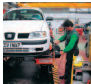
Montaje de los elementos acristalados y alineación del vehículo
