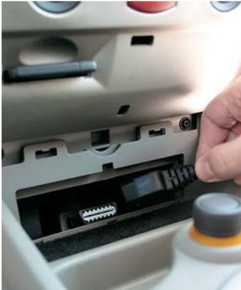
La electrónica aplicada al control de los diferentes sistemas eléctricos de un vehículo ha revolucionado, en las últimas décadas, la automoción, incrementando el número de equipamientos y prestaciones. Esta tecnología precisa, a su vez, del empleo de útiles específicos, denominados *Scan Tools*, que permiten el diagnóstico, la verificación y la reparación de los sistemas a través del diálogo con los módulos de control o calculadores del vehículo.
