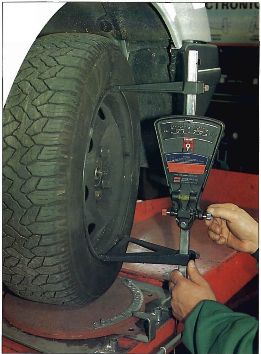
El medidor de nivel controla la caída de la rueda.
