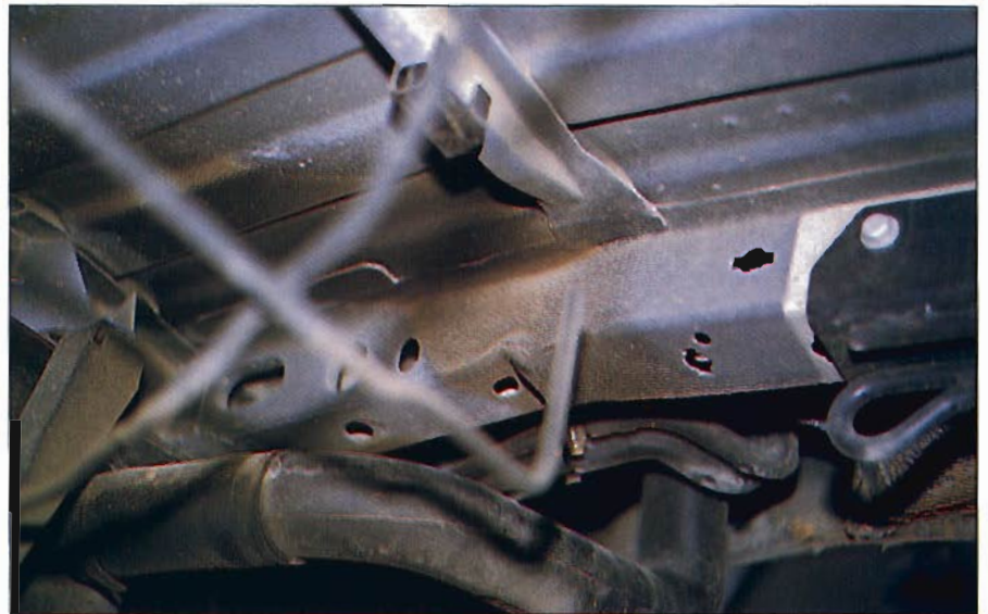
Zona localizada de deformación del largoero.
