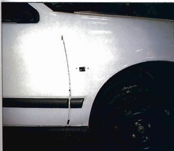
La transmisión de daños también se manifiesta en los desajustes de las piezas móviles.
