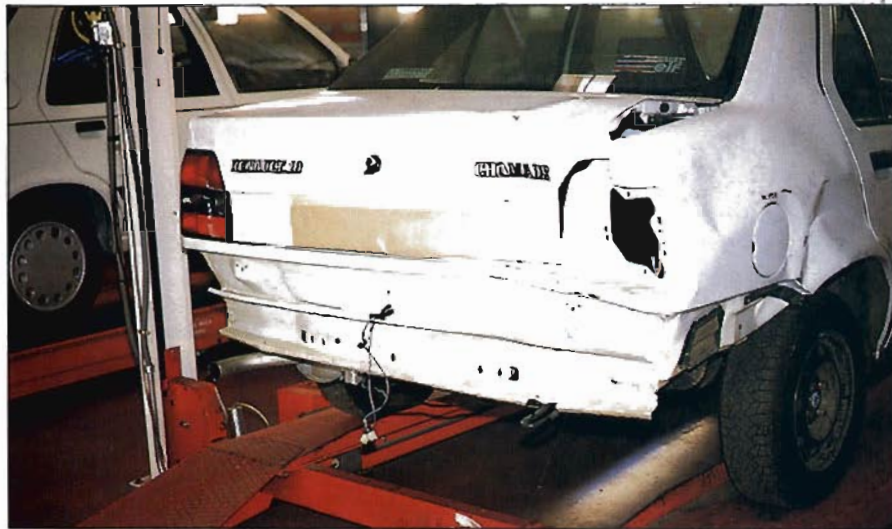
Es fundamental situarse en aquella zona por lo que empezó la deformación.
