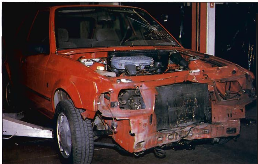
Algunos daños precisan de un desmontaje previo para ser visualizados.
