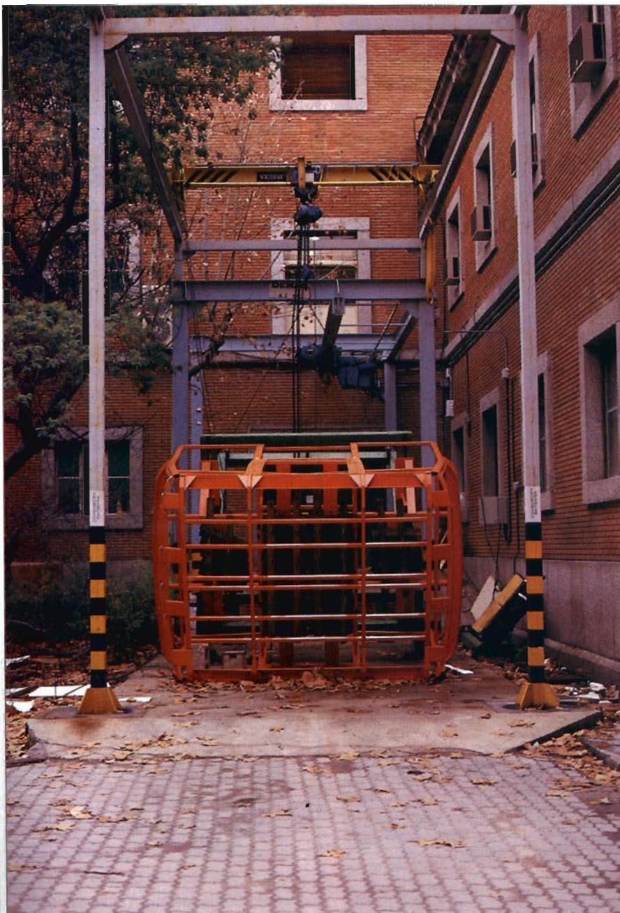
En las instalaciones del GIVET, se realizan pruebas destructivas de la estructura de los autobuses.
