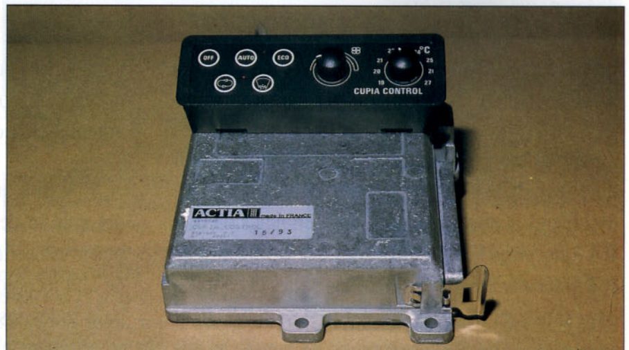
Controles de climatización.
