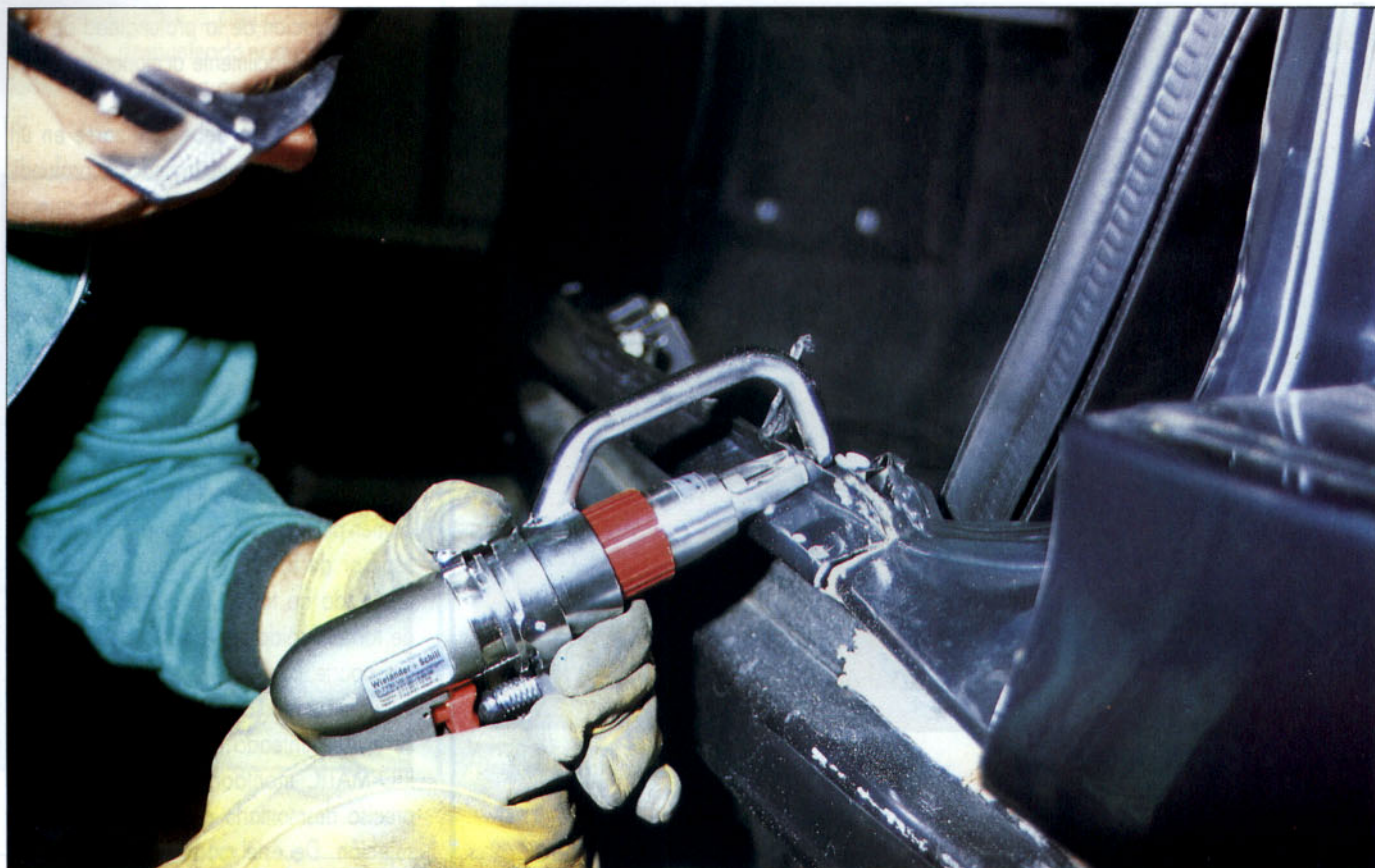
Protección con gafas y guantes utilizando la despunteadora VARIO DRILL WS-90
