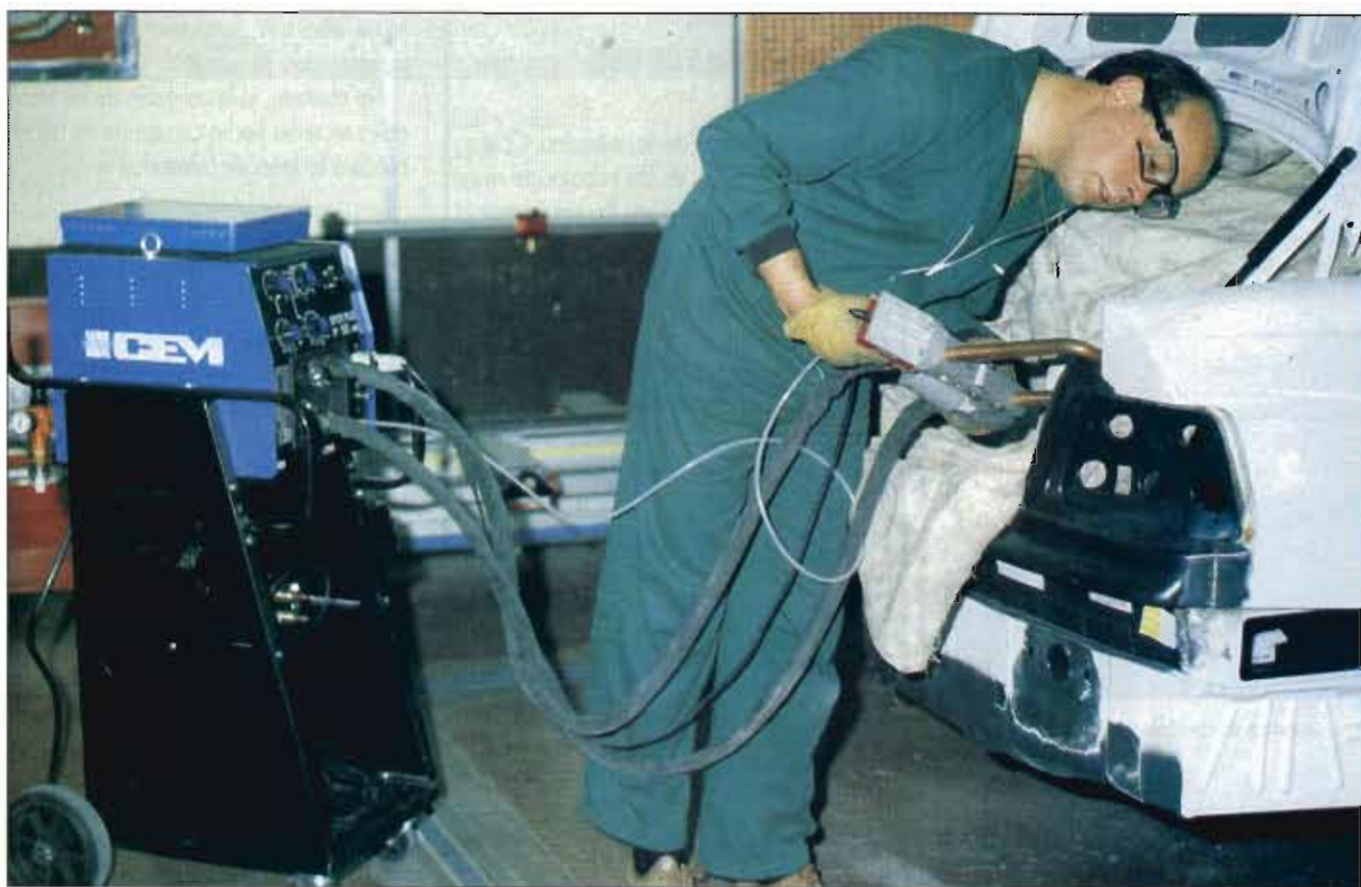
Soldadura por puntos con la pinza neumática.
