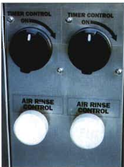
Temporizadores mecánicos del ciclo de lavado.
