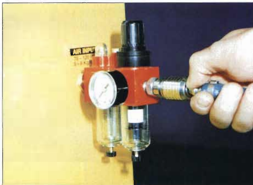
Conexión del aire comprimido y filtros.
