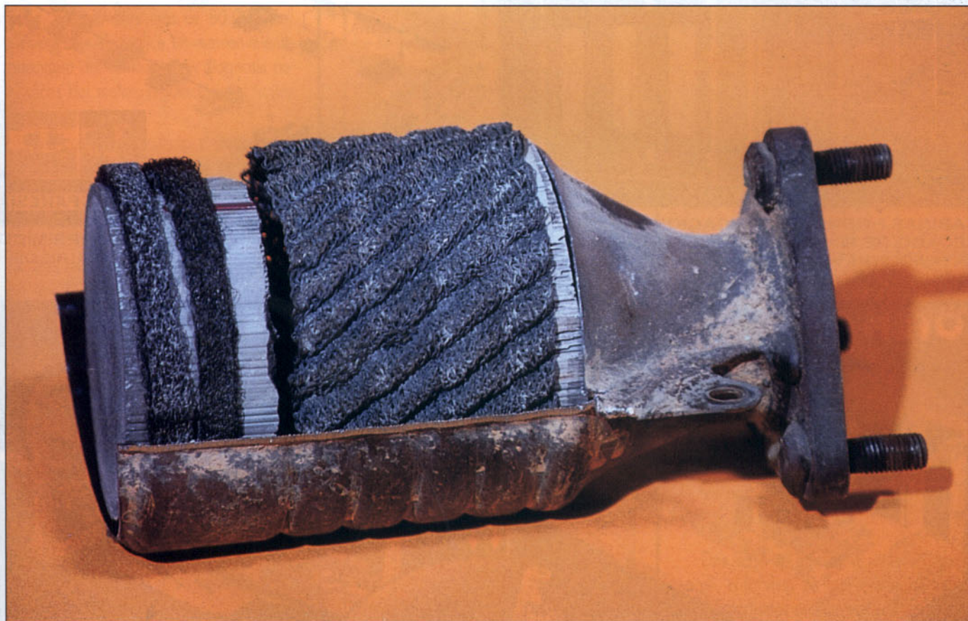
El exceso de emisión de hidrocarburos puede provocar la fusión del monolito cerámico del catalizador.
