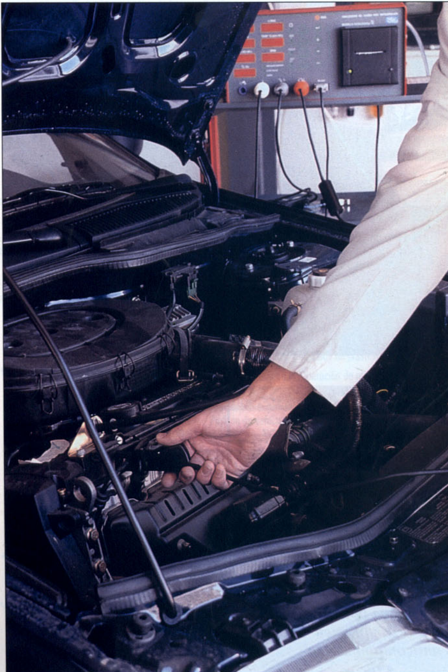
Los analizadores de gases permiten diagnosticar el motor y el catalizador.
