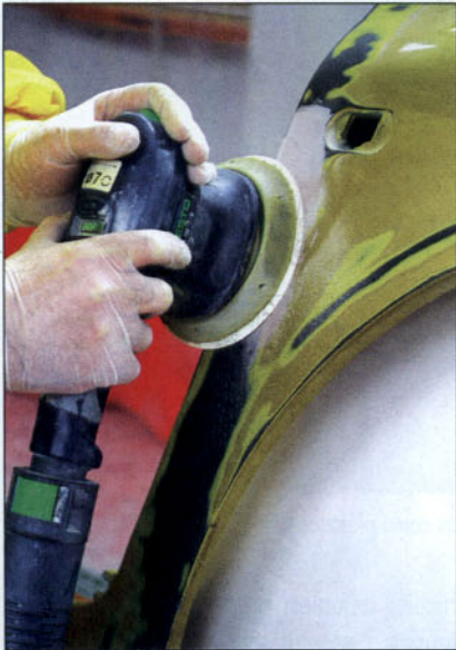
Lijado de la masilla.
