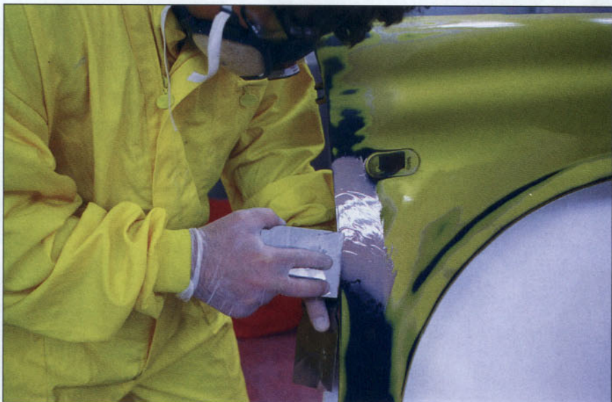
Aplicación de la masilla.
