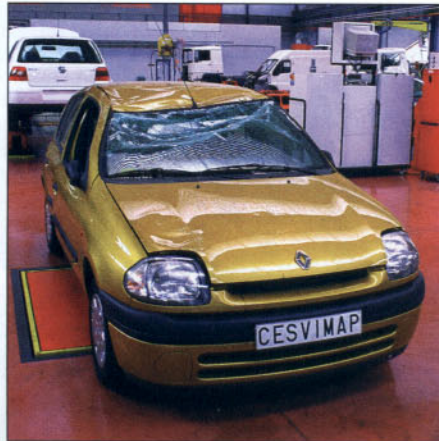
Las aletas del nuevo Clio deben ser tratadas como plásticos termoplásticos.
