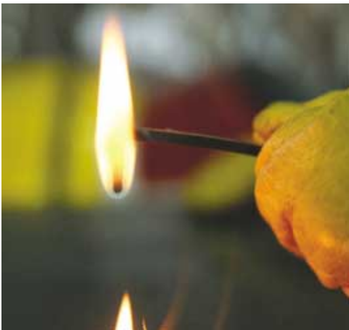
Prueba por combustión
