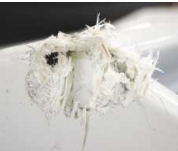
Plástico termoestable con carga de fibra de vidrio
