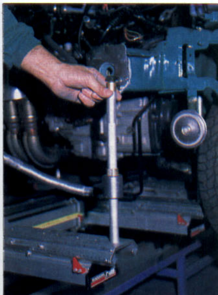
Detalle del control con un medidor de calibres.
