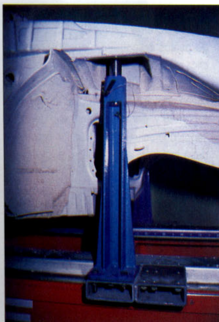
Detalle del control con una bancada de control positivo.
