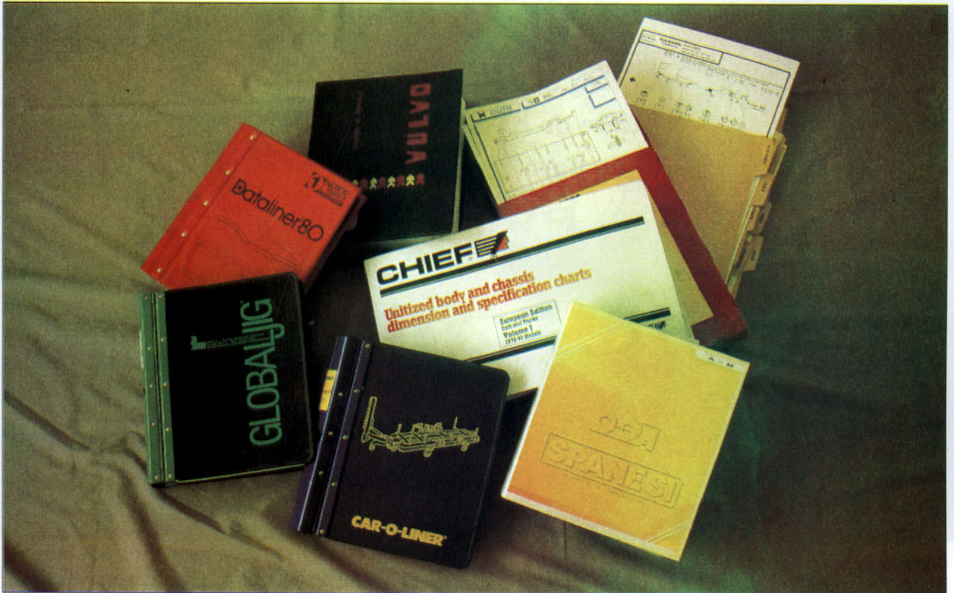
Las fichas de bancada posibilitan un control relativamente rápido de la carrocería.
