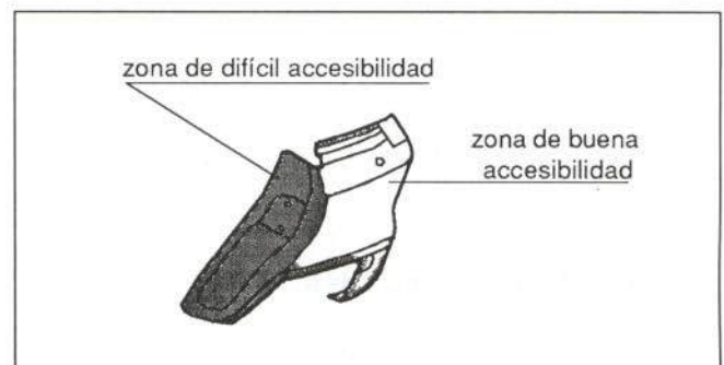
Figura 63.- Accesibilidad de la aleta trasera
