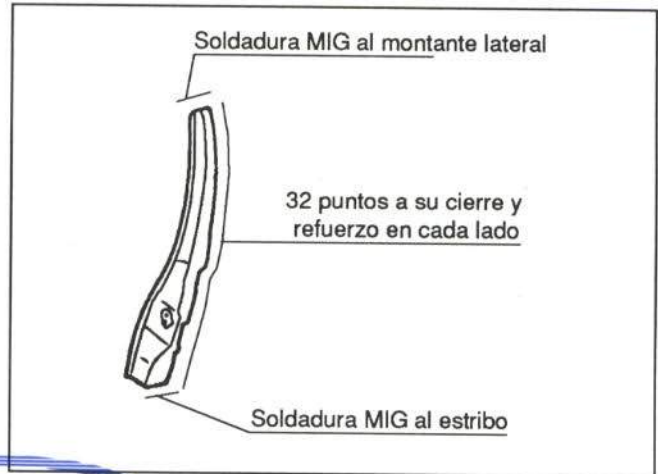
Figura 42.- Unión del pilar central
