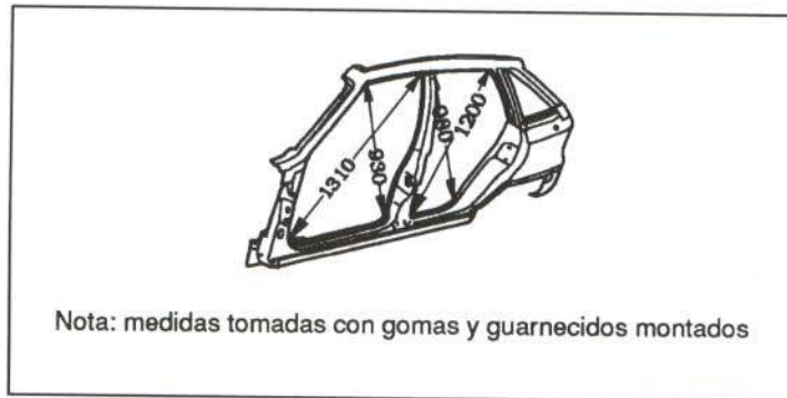
Figura 6.- Medidas de los huecos de puertas
