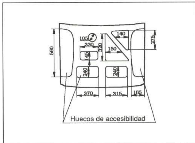
Figura 28.- Accesibilidad del capó delantero
