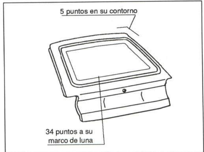
figura 65.- Unión del portón trasero
