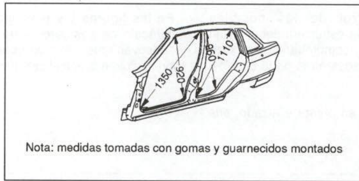
Figura 6.- Medidas de los huecos de puertas
