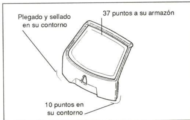
Figura 55.- Unión del portón trasero
