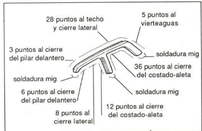
Figura 37.- Unión del montante de techo
