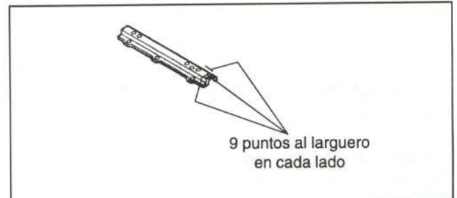
Figura 15.- Unión de la traviesa inferior
