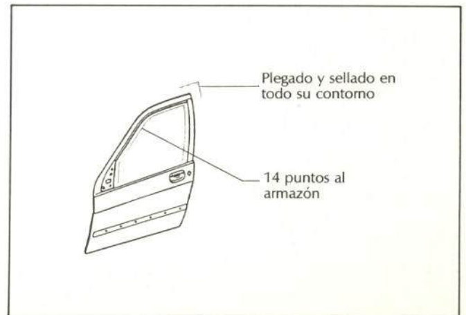
Fig. 32.—Unión del panel de puerta delantera.
