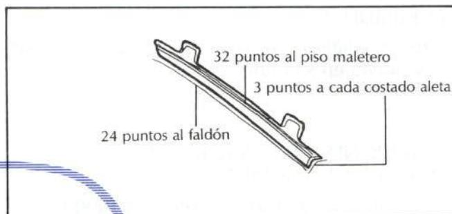
Fig. 55.—Unión de la traviesa inferior.
