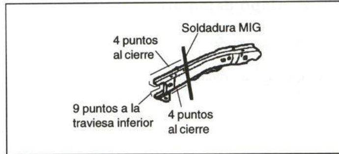
Figura 28.- Unión del larguero delantero
