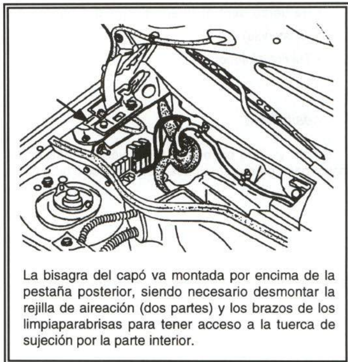
Figura 24.- Esquema de unión posterior de la aleta delantera
