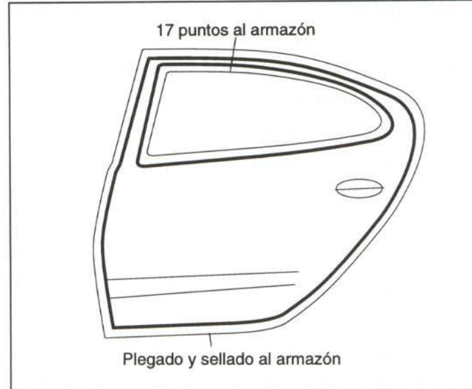
Figura 36.- Unión del panel de puerta trasera
