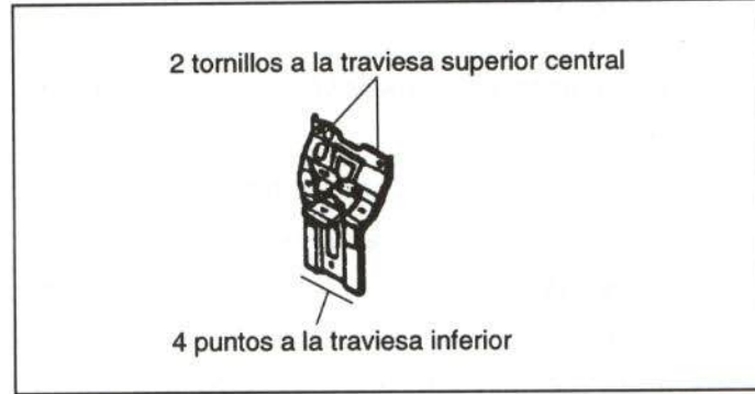
Figura 20.- Unión del soporte central con la carrocería
