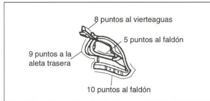
Figura 47.- Unión de la chapa portapilotos
