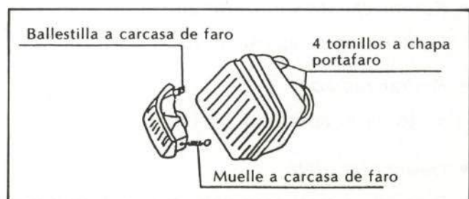
Fig. 10.— Montaje de faro y piloto.
