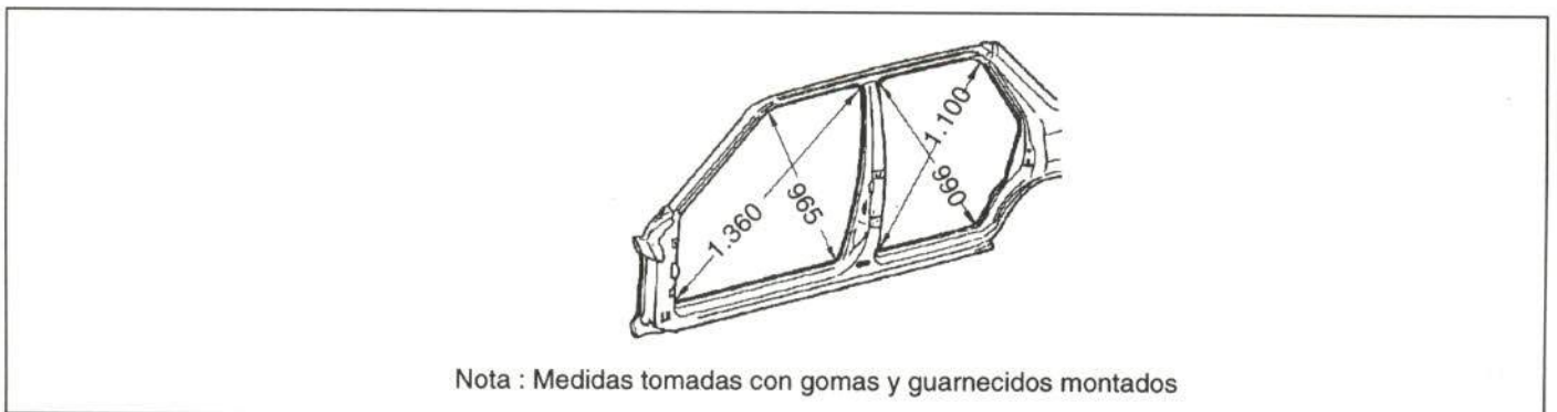
Figura 7.- Dimensiones de huecos de puerta
