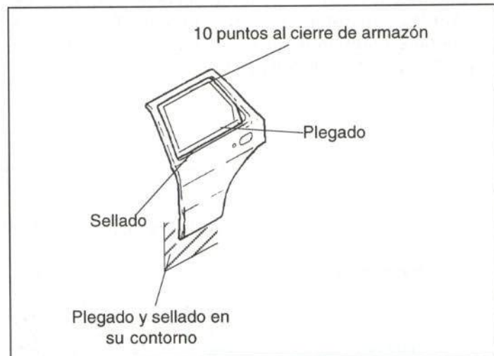
Figura 32.- Unión de la puerta trasera
