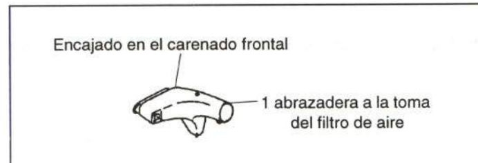
Figura 47.- Unión de la toma de aire
