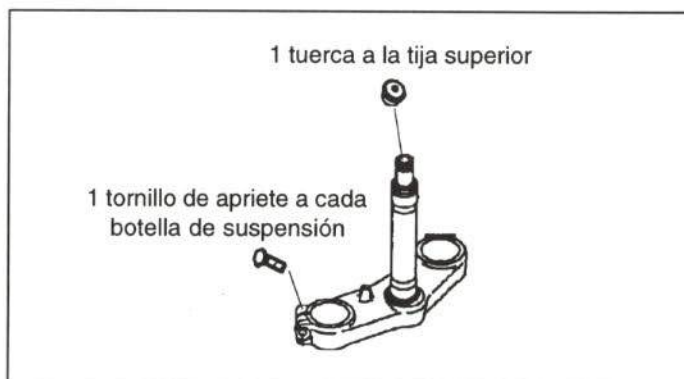
Figura 40.- Unión de la tija inferior
