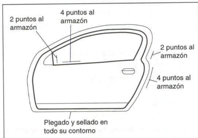
Figura 26.- Unión del panel de puerta
