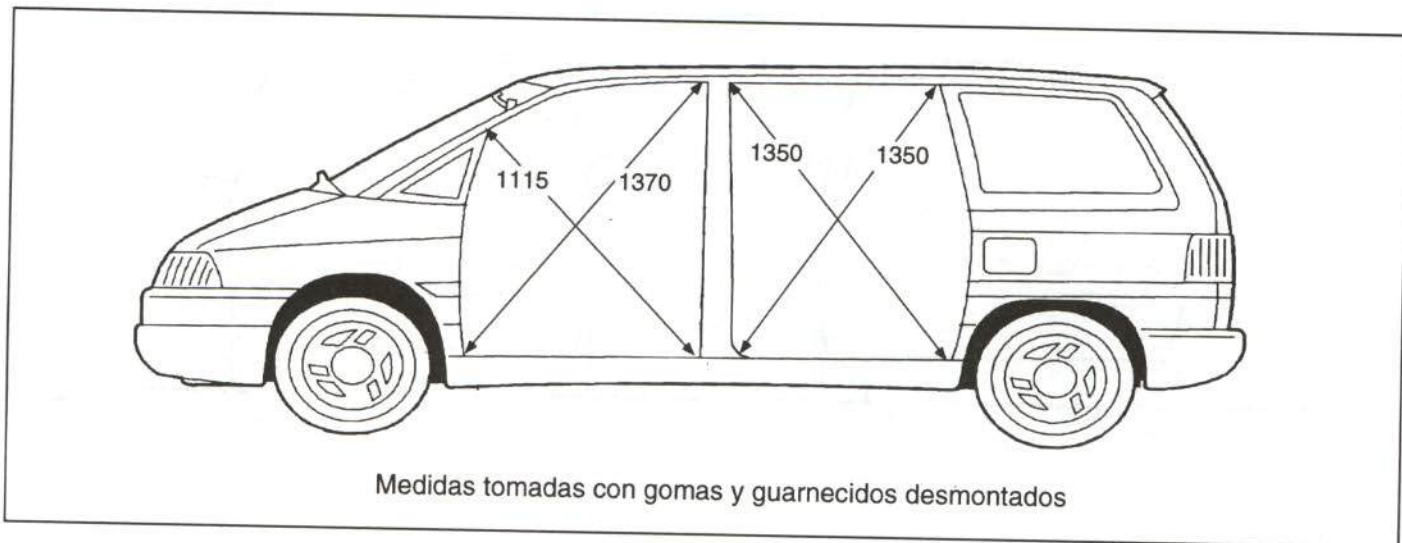
Figura 6.- Medidas de los huecos de puerta
