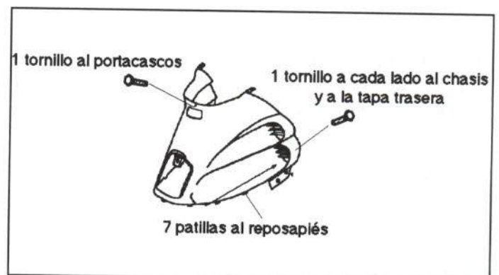
Figura 21.- Unión del cuerpo inferior de sillín
