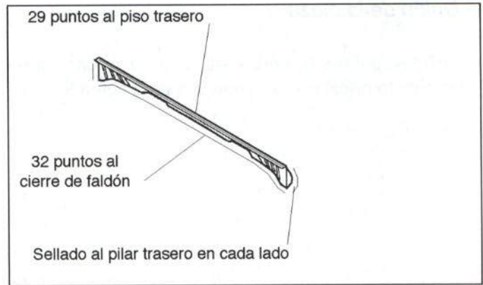
Figura 53.- Fijación del faldón trasero
