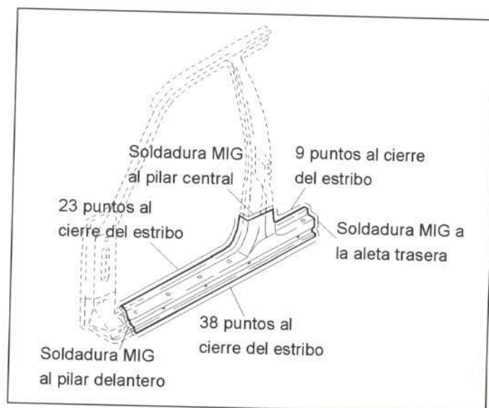
Figura 35.- Unión del estribo bajo puertas
