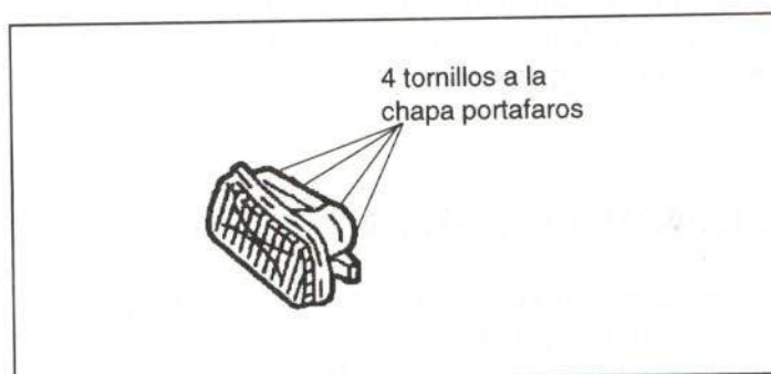
Figura 11.- Unión del conjunto faro-piloto delantero
