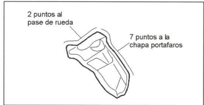
Figura 22.- Unión de la traviesa lateral superior
