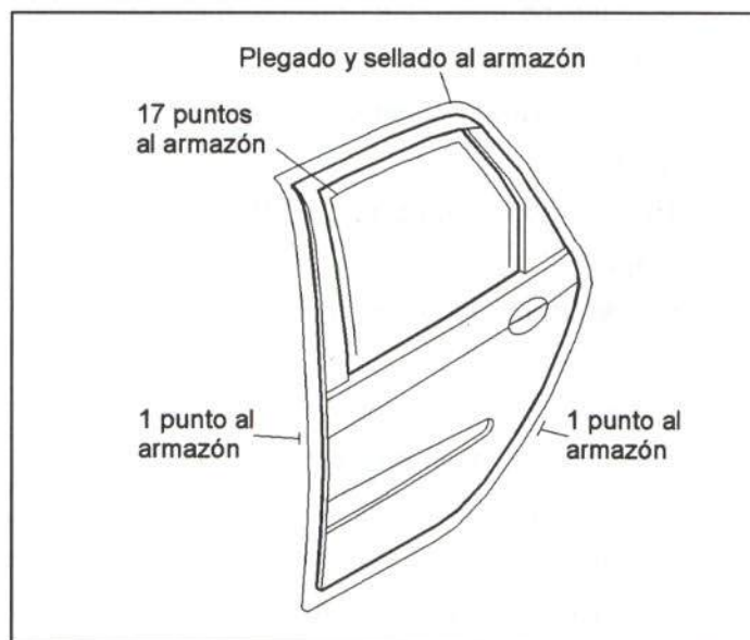
Figura 37.- Unión del panel de puerta trasera
