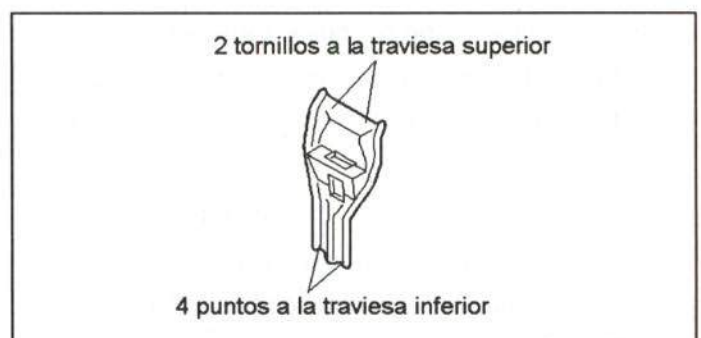
Figura 23.- Unión del refuerzo central
