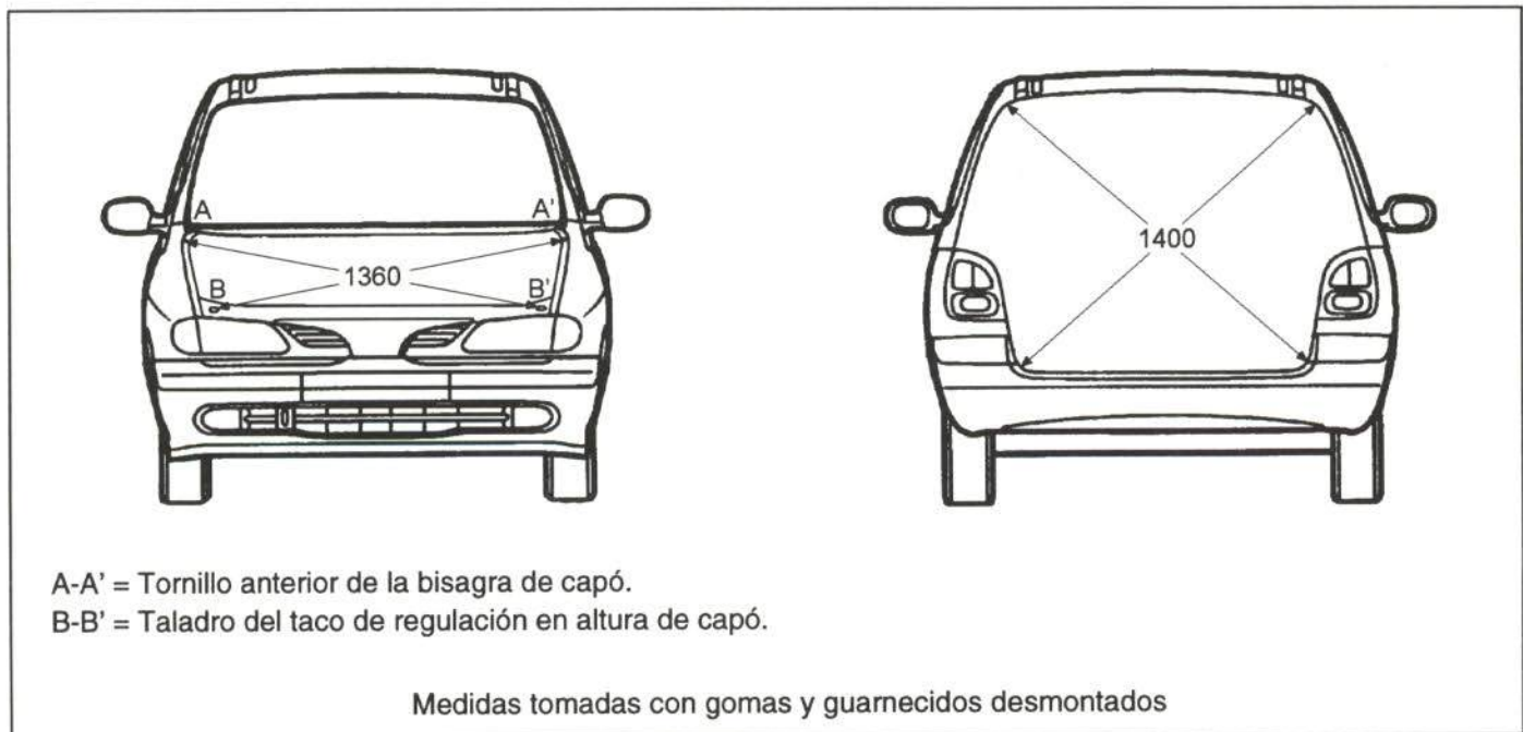
Figura 5.- Cotas de la parte delantera y trasera
