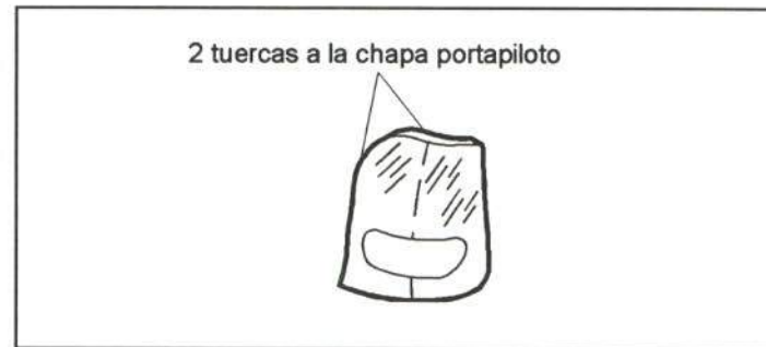
Figura 42.- Unión del piloto trasero
