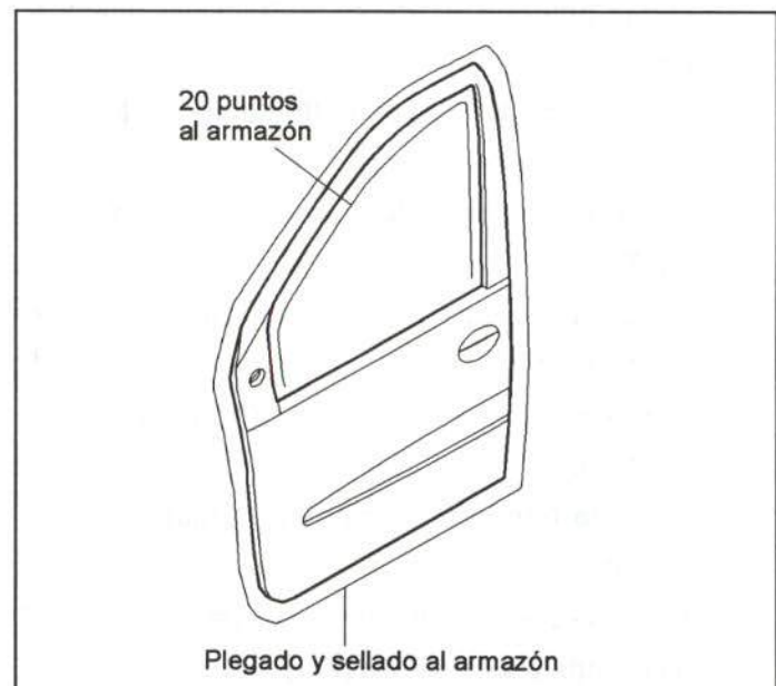
Figura 34.- Unión del panel de puerta delantera
