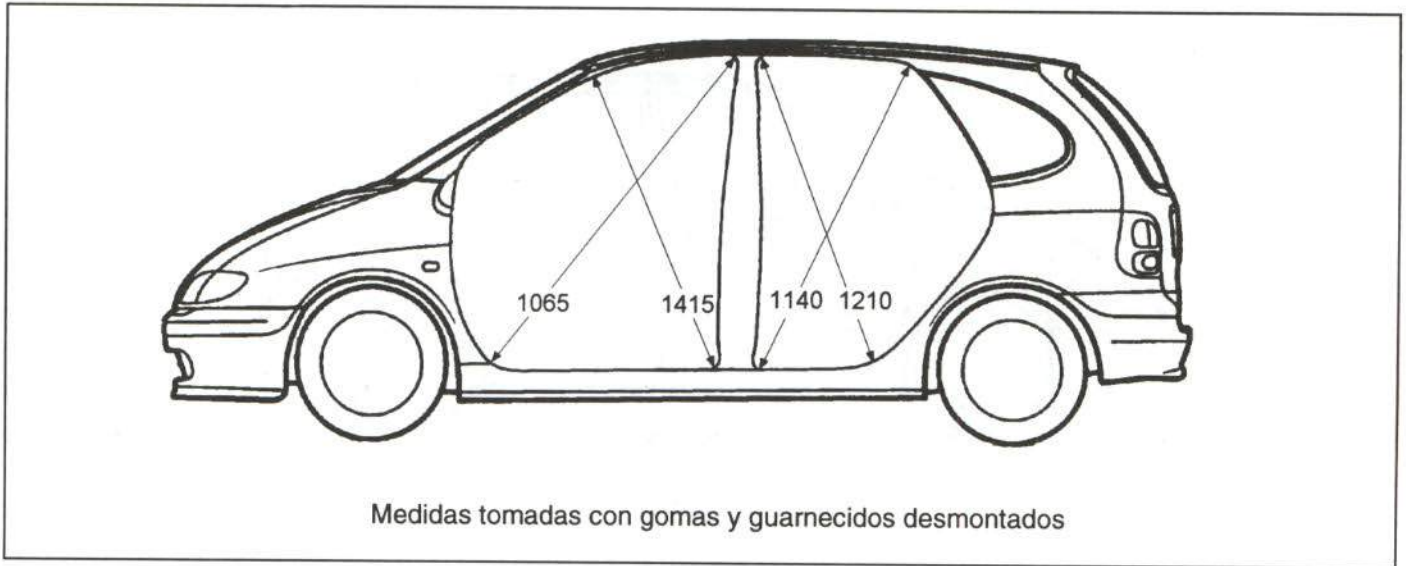
Figura 6.- Medidas de los huecos de puerta
