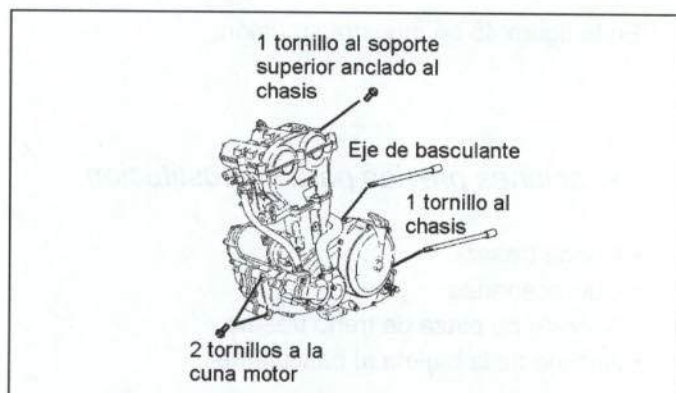
Figura 48.- Unión del conjunto motor
