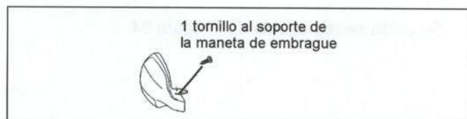
Figura 36.- Unión del guardamanos
