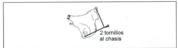
Figura 44.- Unión del depósito de agua
