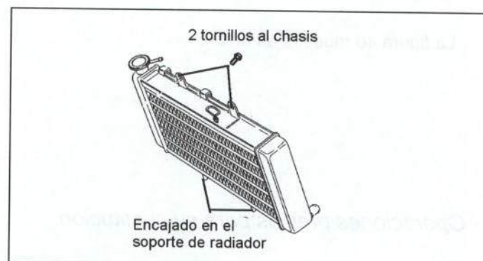
Figura 42.- Unión del radiador
