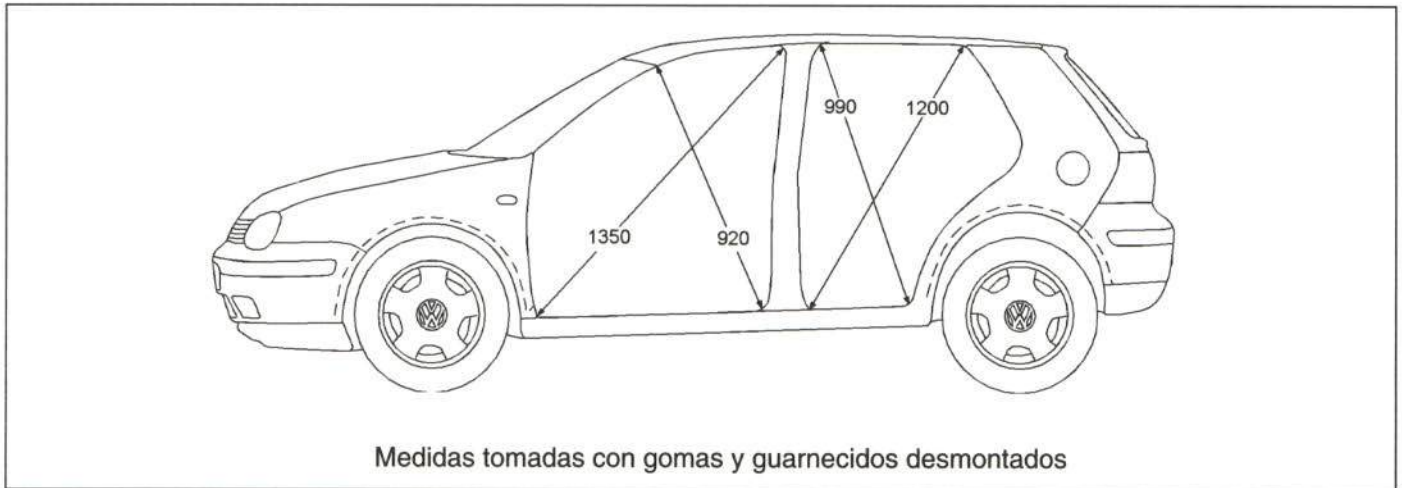
Figura 6.- Medidas de los huecos de puerta
