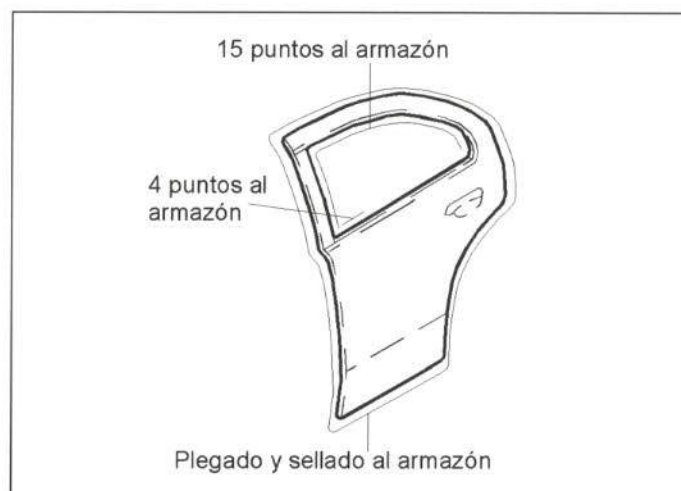
Figura 40.- Unión del panel de puerta trasera
