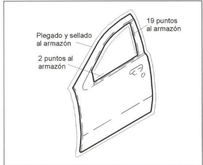
Figura 37.- Unión del panel de puerta delantera
