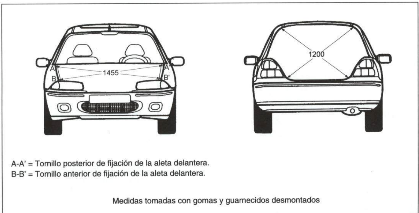
Figura 5.- Cotas de la parte delantera y trasera
