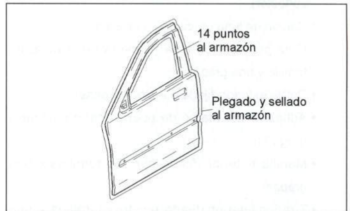
Figura 36.- Unión del panel de puerta delantera
