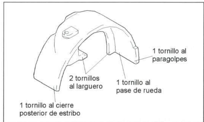
Figura 45.- Unión del guardabarros trasero
