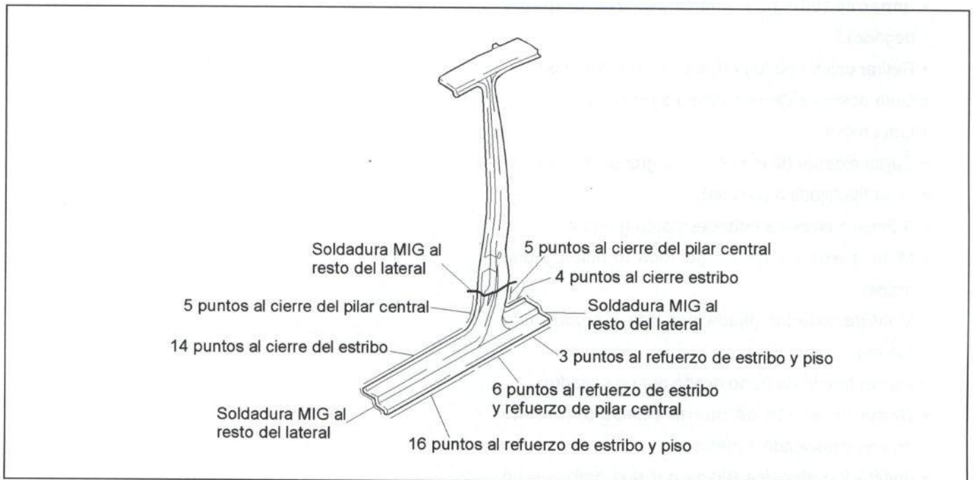
Figura 41.- Unión del estribo bajo puertas
