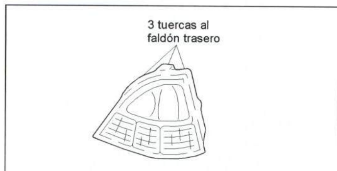
Figura 44.- Unión del piloto trasero
