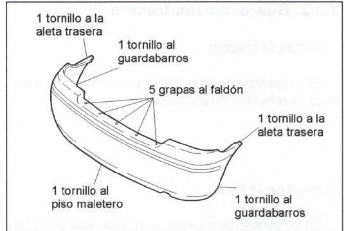
Figura 47.- Unión del paragolpes trasero
