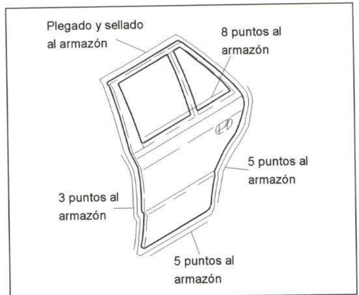
Figura 39. - Unión del panel de puerta trasera
