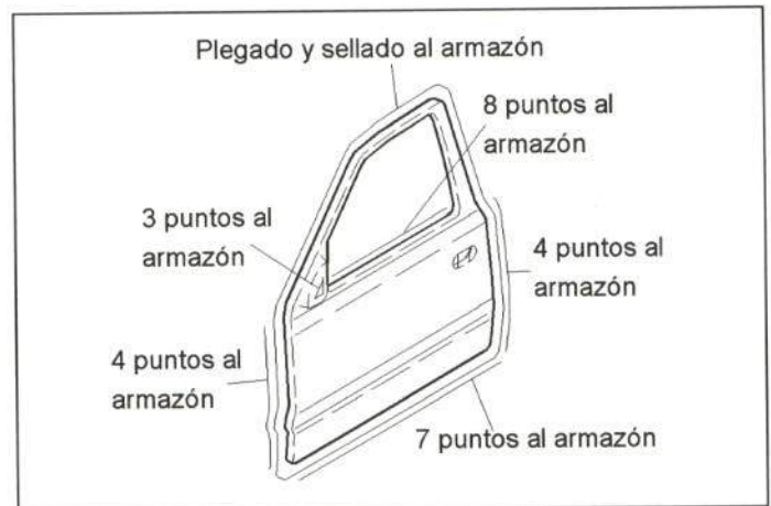
Figura 36.- Unión del panel de puerta delantera
