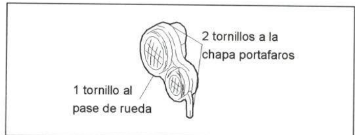
Figura 16.- Unión del faro delantero
