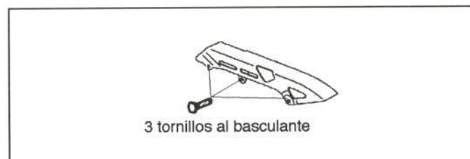
Figura 23.- Unión del piloto trasero
