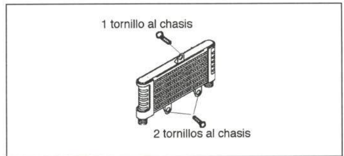
Figura 43.- Unión del radiador de aceite
