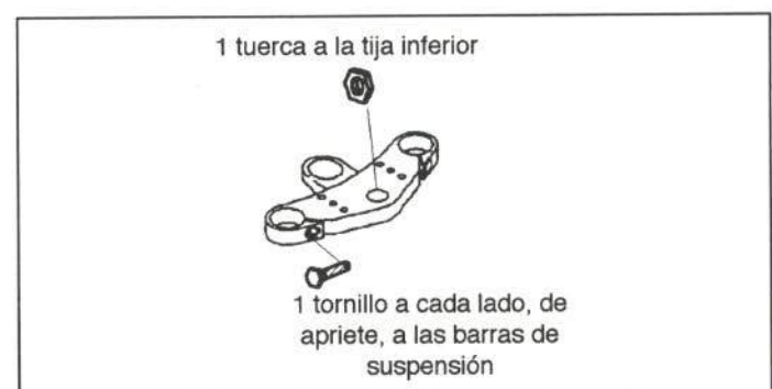
Figura 40.- Unión de la tija superior
