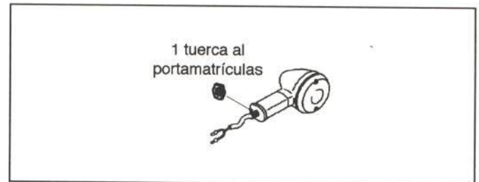
Figura 20.- Unión del intermitente trasero
