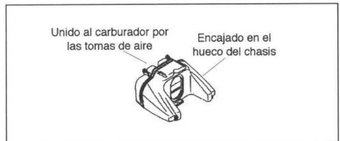
Figura 33.- Unión de la caja del filtro de aire
