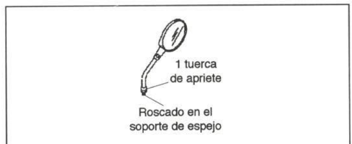
Figura 34.- Unión del espejo retrovisor
