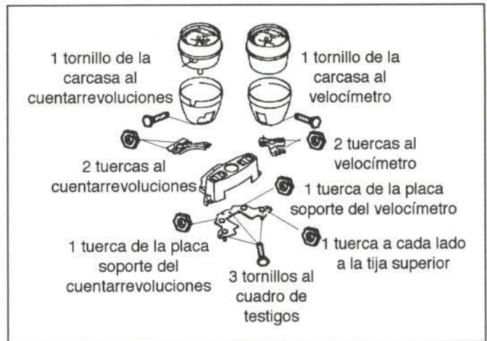
Figura 38.- Unión del cuadro de relojes
