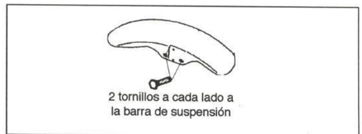
Figura 37.- Unión del guardabarros delantero
