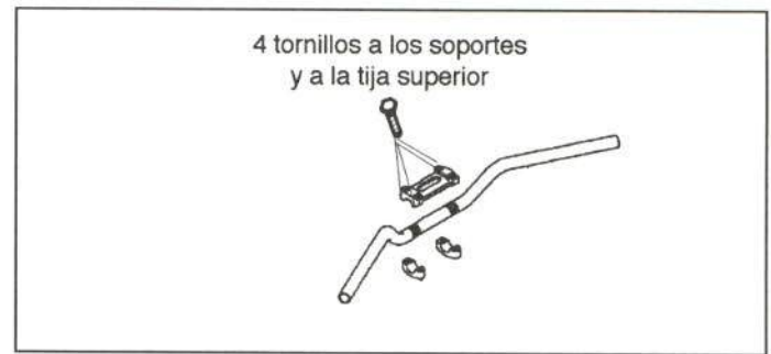
Figura 35.- Unión del manillar
