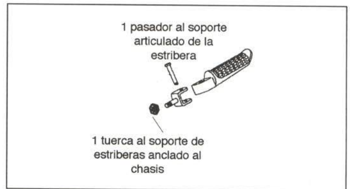
Figura 26.- Unión de la estribera de conductor
