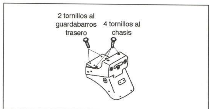
Figura 21.- Unión del portamatrículas
