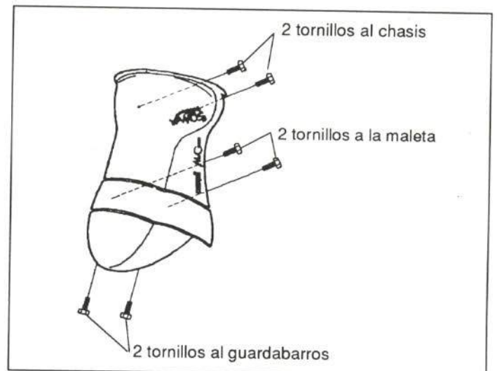
Figura 16.- Fijación de la coraza frontal
