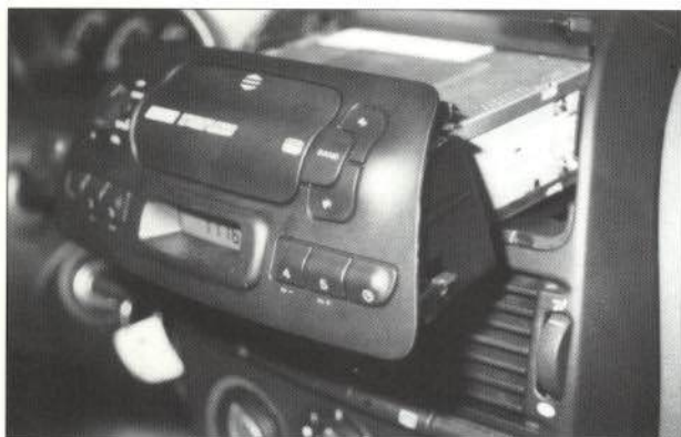
Figura 5.-Radiocasete desmontado de su alojamiento.
