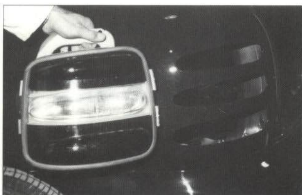
Figura 6.-Orificios practicados en la aleta para alojar el piloto.
