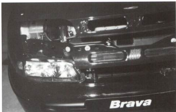
Figura 1.-Conjunto faro-piloto integrado y rejilla desmontada junto al alojamiento.
